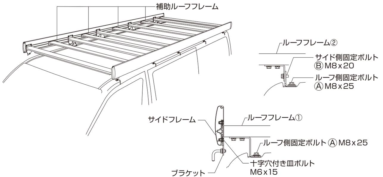
○サイドフレームとブラケットを固定する十字穴付き皿ボルトを全て緩みが無いよう締付けてください。
